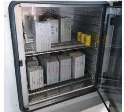
Κλιματικός θάλαμος με πρισματικά δοκίμια για επιταχυνόμενη ενανθράκωση (Ελβετικό Πρότυπο SIA 262/1-X)
